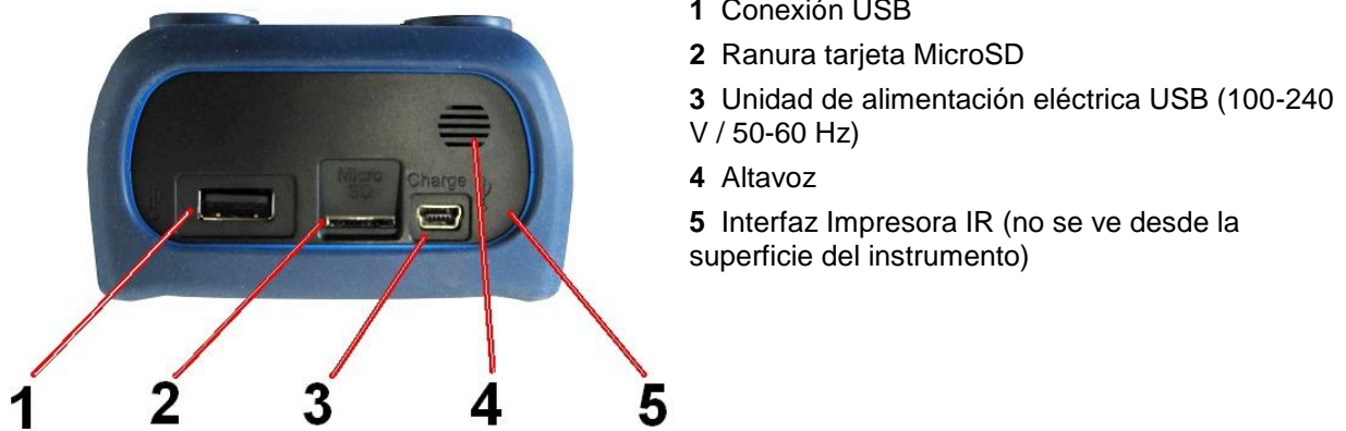
Fig. 2: Esquema de conexión (lateral)
